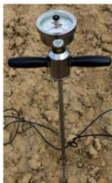
Figuur B: Handsondeerapparaat met aan de bovenkant de meter die op nul gedraaid moet worden.
