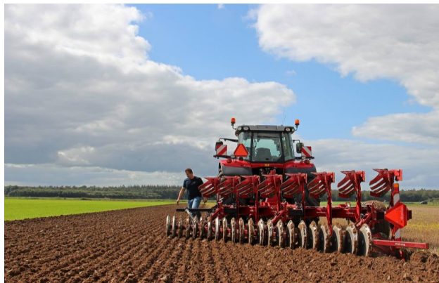
Figuur 18: Het gebruik van een eco-ploeg waardoor ondiep geploegd en bovenover gereden wordt.
