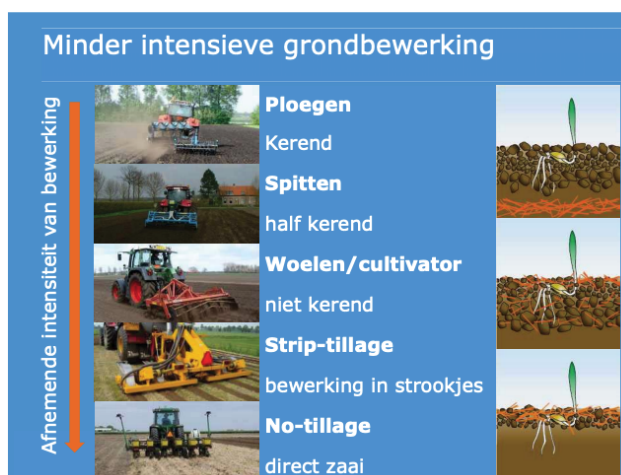
Figuur 16: de gradatie van ploegen naar niet kerende grondbewerking.
