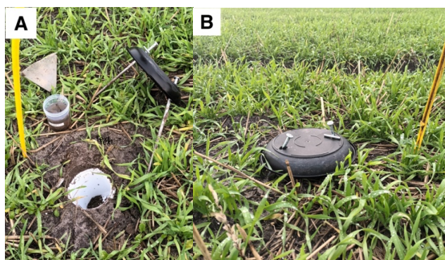
Figuur 5: op A is te zien uit welke onderdelen een insectenval bestaat. Op B is te zien hoe het insecten val op het veld eruitzagt. De vallen werden gemarkeerd met gekleurde stokken.
