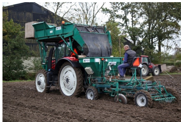
Figuur 10: Een plantmachine voor het planten van diverse soorten bloembollen (Agrifirm, 2017).
