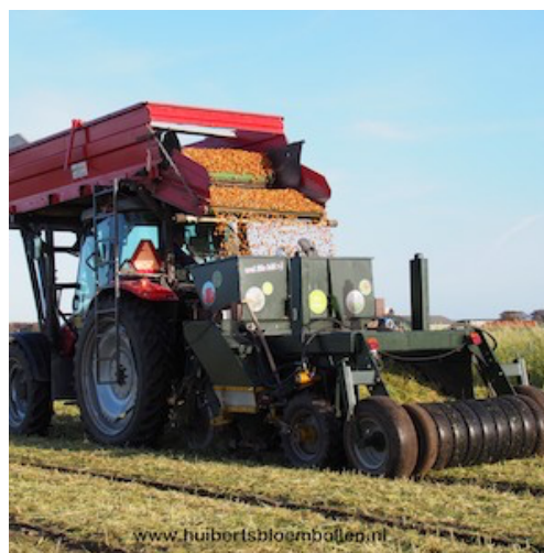
Figuur 2: De aangepaste plantmachine voor onderzaaien van de bloembollen onder de groenbemester. Hiervoor is een ondergraszaaier omgebouwd. Verkregen van Huibertsbloembollen.nl op 07/01/2023.
