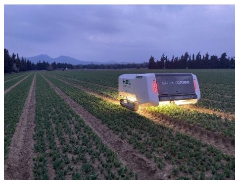
Figuur 11: De moderne H2L robot om virusziekten in de bloembollen te herkennen en vervolgens direct te bestrijden.
