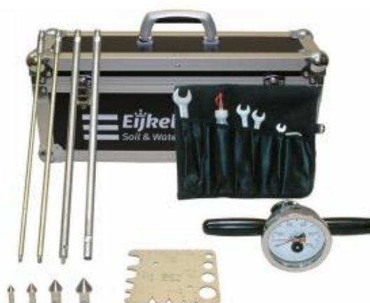
Afbeelding 3: Volledige handsondeerapparaat-set inclusief steeksleutels en cone check slijtage plaat.
