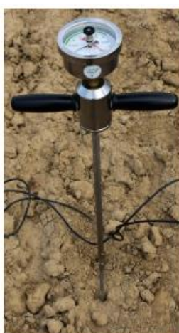
Afbeelding 2: Handsondeerapparaat van Eijkelkamp Soil and Water in het veld. (Bron: Eva Fletcher, 2022)
