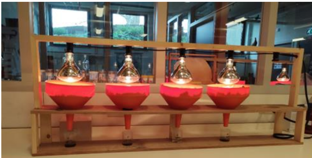
Afbeelding 2: Opstelling van de Berlesetrichter. De lamp boven de trechter verwarmt de grond, hierdoor kruipt het bodemleven naar beneden en valt in het potje met isopropanol.
