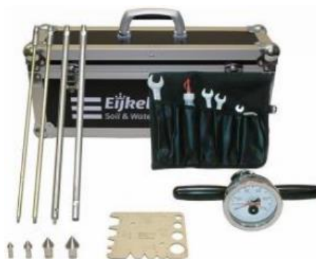
Figuur C: Volledige handsondeerapparaat-set inclusief steeksleutels en cone check slijtage plaat.
