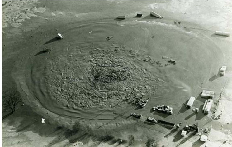
Figuur 10 Luchtfoto van de modderpoel die gevormd werd door de ondergrondse blow-out bij een gasboring (SLN-02) in 1965. Aan de rand van de krater zijn nog een aantal weggezakte vrachtwagens zichtbaar. (Foto: Streekeigen Sleen).
